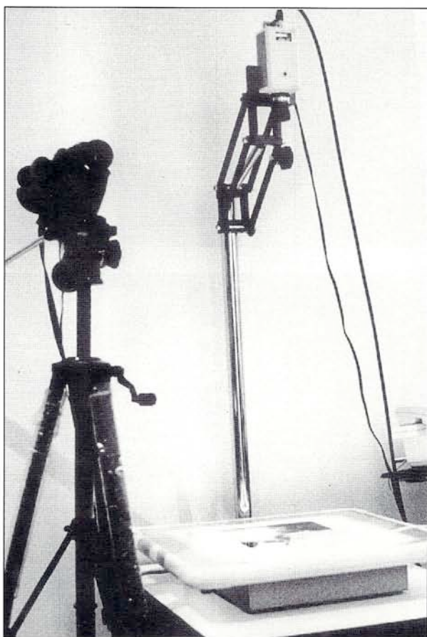
Figura 3 - 4.—Se muestran los periféricos del ordenador: dos videocámaras y un negatoscopio para introducir la telerradiografía lateral.
